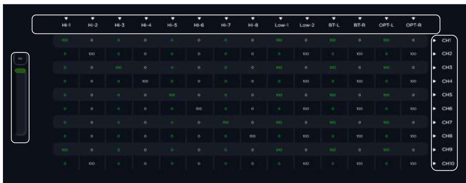
Для настройки маршрутизации сигнала используйте таблицу маршрутизации, где по горизонтали расположены все возможные входы сигнала, а по вертикали все возможные выходы сигнала.
